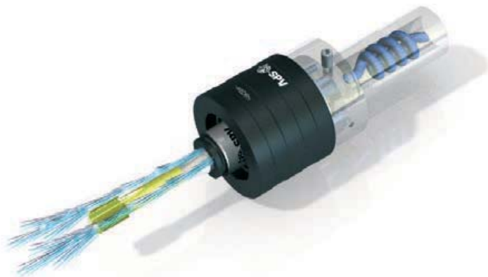
CGS-C tillsammans med tapphållare typ TC erhålles kylning längs med skaftet på gängtappen.
