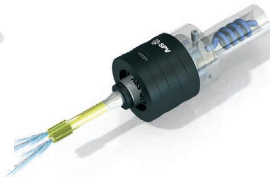
CGS-C tillsammans med tapphållare typ T erhålles kylning igenom gängtappar utrustade med kylkanaler.
